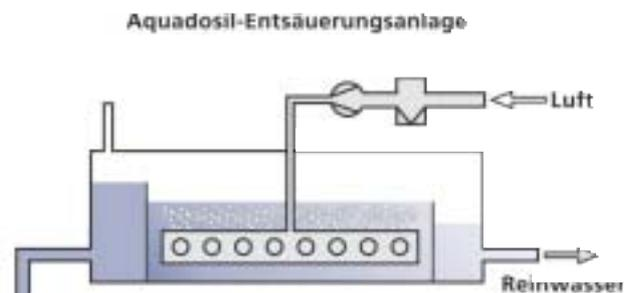
Die Aufbereitung erfolgt ohne Zwischenpumpstufe; je nach örtlichen Verhältnissen kann die Entsäuerung auch räumlich getrennt erfolgen (z.B. im Hochbehälter).
